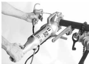
Roscado utilizando una llave de tuberías como brazo de soporte
