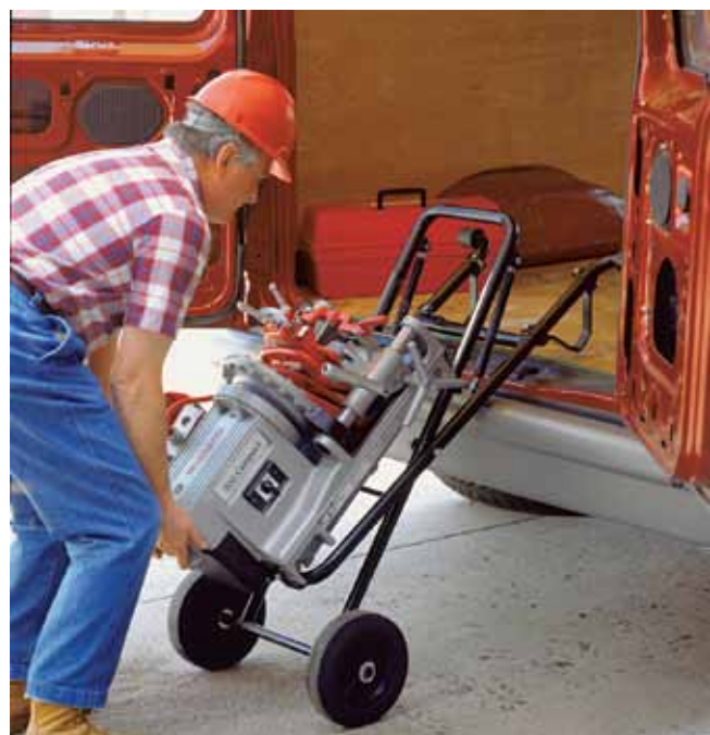
El modelo 300 Compact es una opción versátil para trabajos de roscado y ranurado.
