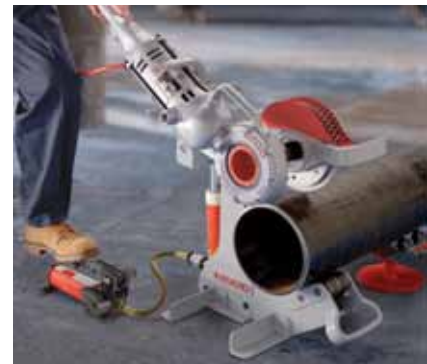
Cortador de tuberías modelo 258 con accionamiento eléctrico No. 700 durante la realización de un corte.
